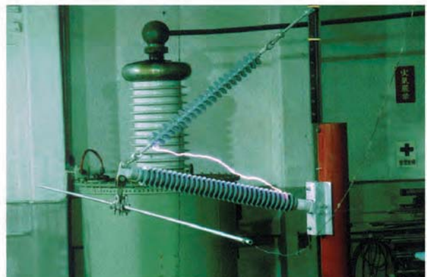
Fig. 9 - Impulse flashover test
